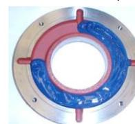
Figura 7.3: Anillo de fijación externo del cojinete
