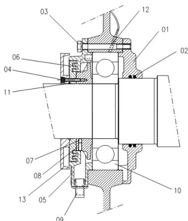
Figura 7.2: Partes del cojinete de rodamiento a grasa
