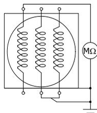
Figura 4.2: Conexión del megóhmetro en fases separadas
