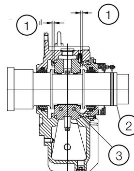
Figura 4.14: Cojinete de deslizamiento
