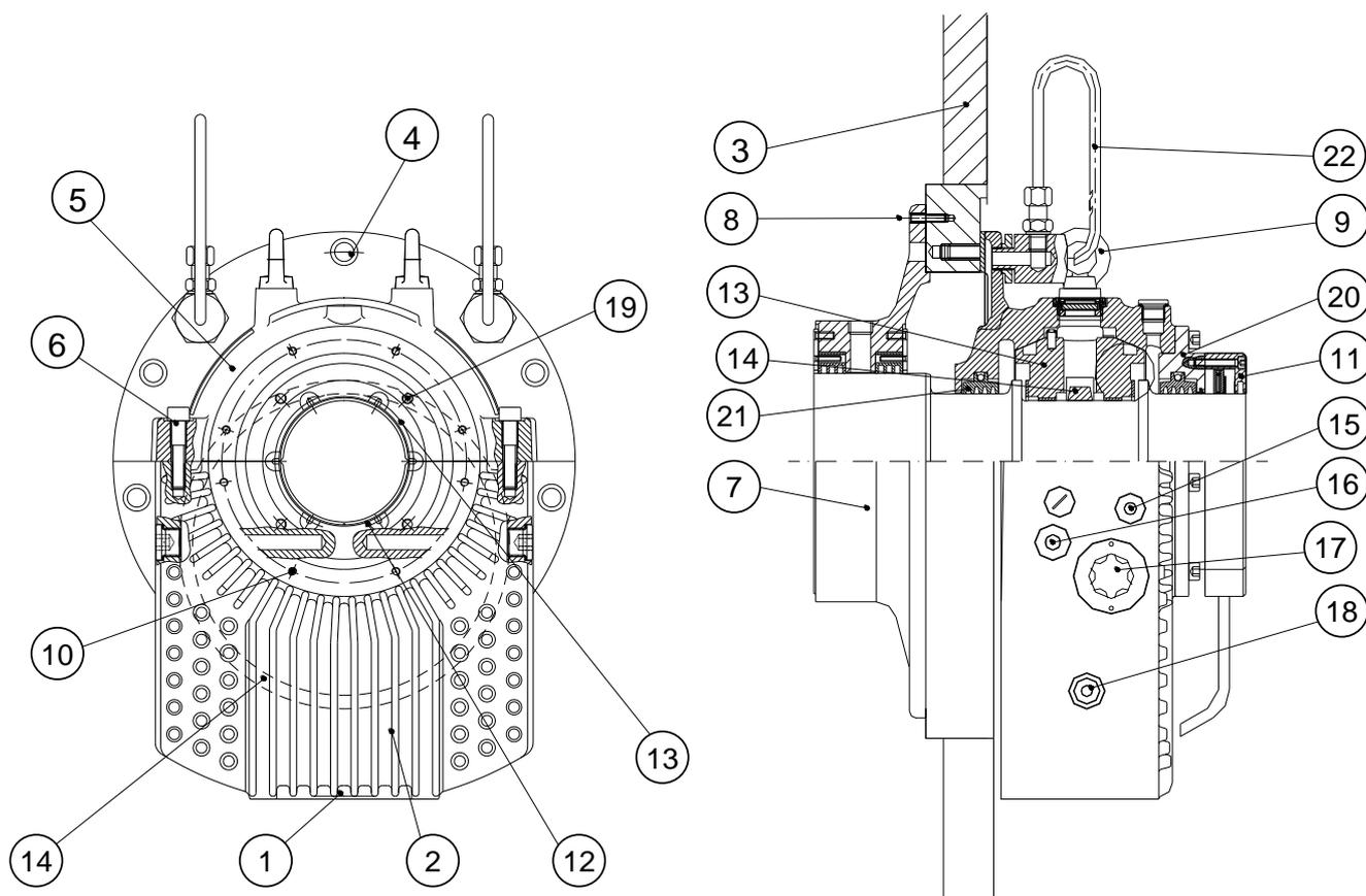
Figura 7.5: Partes del cojinete de deslizamiento
