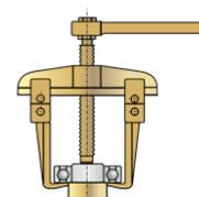
Figura 7.4: Dispositivo para extraer el rodamiento
