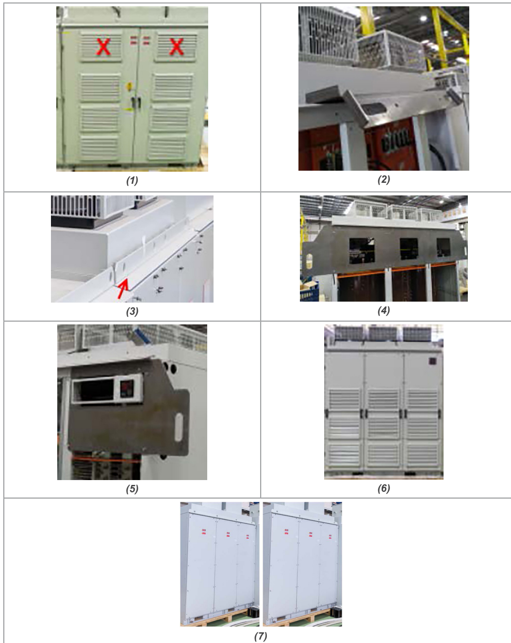
Figur 6.4: Procedur för att ta bort förstärkningarna för lufttransport från MVW3000
