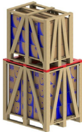
الشكل 5.5: استخدام عوارض إضافية للتكديس
