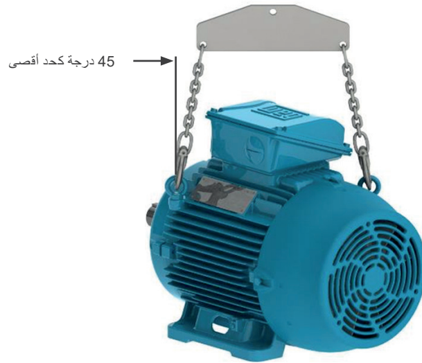
الشكل 4.4: أقصى زاوية ناتجة للمحركات المزودة بمسمارين أو أكثر للرفع
