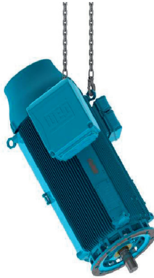
الشكل 4.17: رفع محركات HGF و W50 و W51 HD بواسطة مسامير العروة في الطرف غير المحرك
