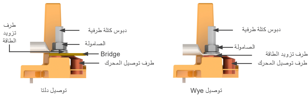
الشكل 6.15: توصيل كتل أطراف التوصيل *KWMV و *KWL
