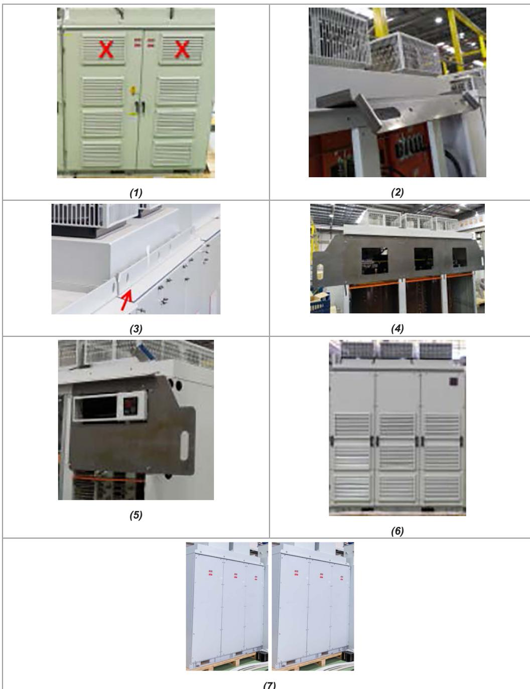
Figure 6.4: Procédure pour retirer les renforts de transport aérien du MVW3000
