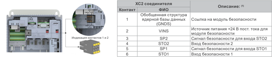
Рис 9.3: Расположение и вывод разъема XC2 (модуль безопасности)
