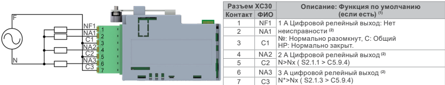
Рис 9.3: Расположение и вывод разъема XC2 (модуль безопасности)
