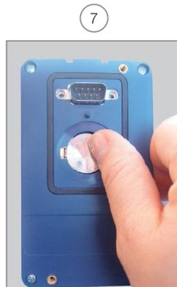
Die Batterie in das Batteriefach drücken
