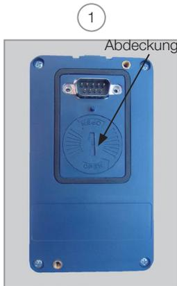
Deckel für Batterie-Zugang
