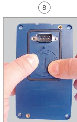
Die Abdeckung wieder aufsetzen und im Uhrzeigersinn drehen
