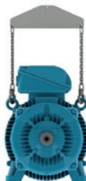
Rys. 4.6 - Używanie zawiesia belkowego do podnoszenia
