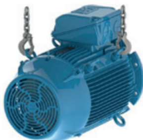
Rys. 4.9 - Wyjmowanie silnika z opakowania
