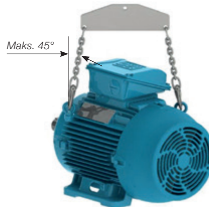
Rys. 4.4 - Maksymalny kąt wynikowy w silnikach z przynajmniej dwiema śrubami oczkowymi.
