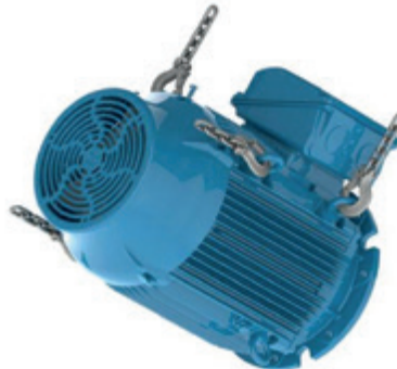
Rys. 4.18 - Obracanie silnika do pozycji poziomej
