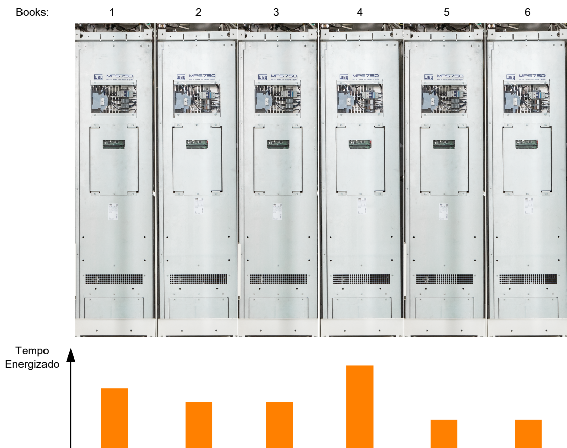
Figura 5.1: Equalização da energia gerada nos MPS750.
