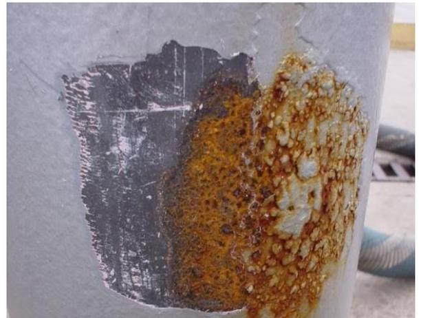
Figura 17: Tubulação pintada sobre carepa de laminação
