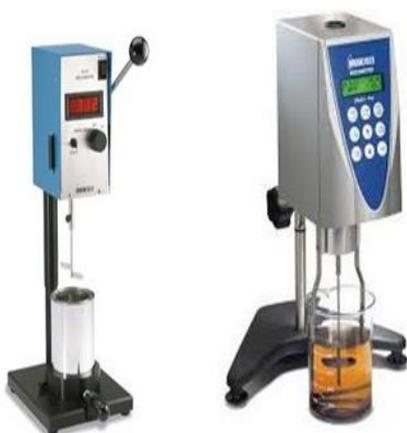
Figura 35: Exemplo de viscosímetro Brookfield
