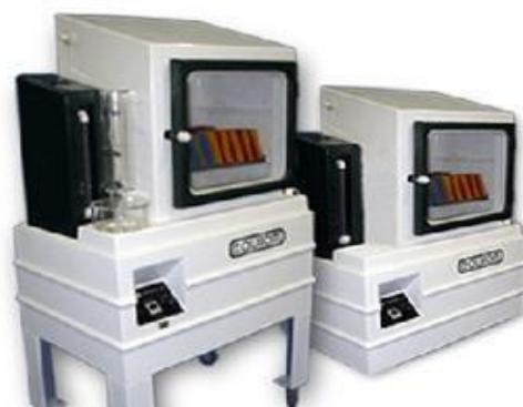
Figura 47: Câmara de SO<sub>2</sub>
