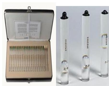
Figura 36: Exemplo de viscosímetro de Gardner
