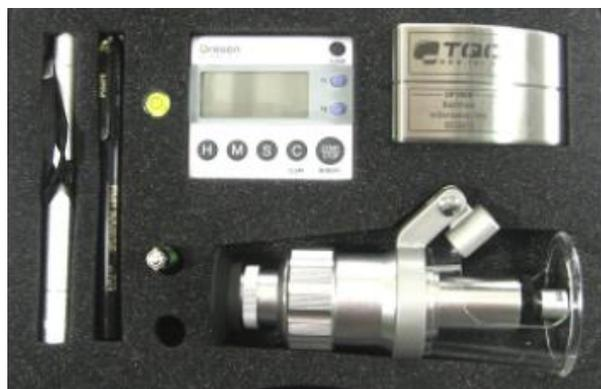
Figura 50: Exemplo de dispositivo para medir dureza pelo método Buchholz
