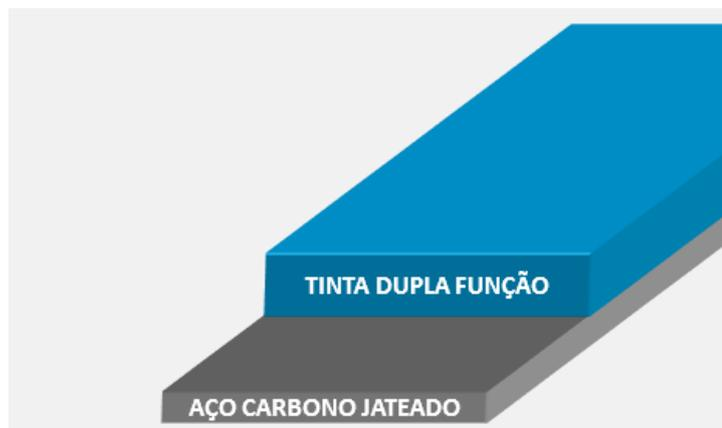
Figura 4: Esquema de pintura para tintas dupla função
