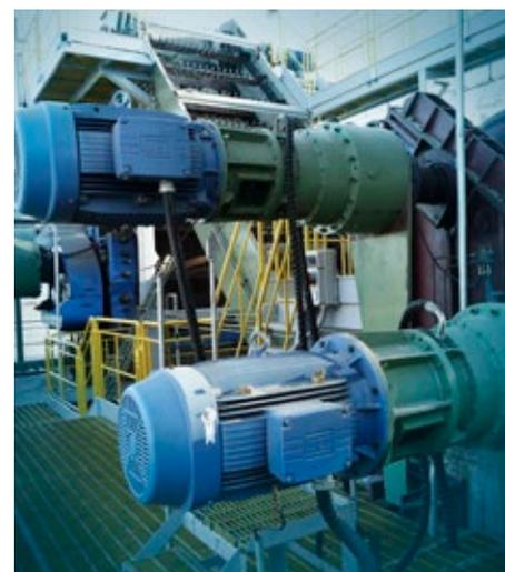
WEG dispone de una **solución completa para la optimización y el control de la extracción en el Difusor**, pudiendo suministrar equipos para el control optimizado de la percolación, actuando con precisión en los indicadores de proceso (KPIs) y ajustando niveles, velocidades y temperaturas, incluyendo las protecciones contra desalineación, control de las bombas de agua/caldo, sincronizando el desagüe y el secado.
