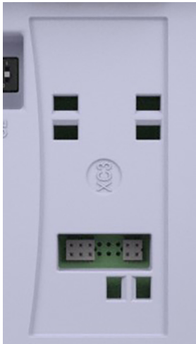
Figure 5.7: Connecteur pour accessoires Bluetooth ou Ethernet du XC3
