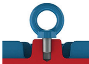
Figure 5 - Feil stramming av øyebolten.
