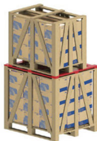
Figur 28 - Bruk av ekstra lekter for stabling.
