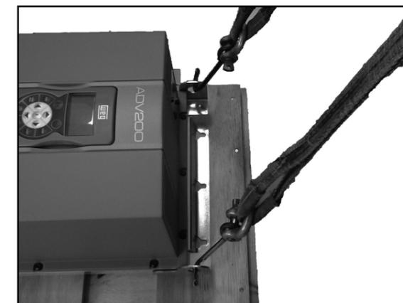
A remoção do drive da caixa deve ser realizada utilizando talhas de corrente ou guindaste, prendendo dois tirantes nos olhais apropriados do drive.
