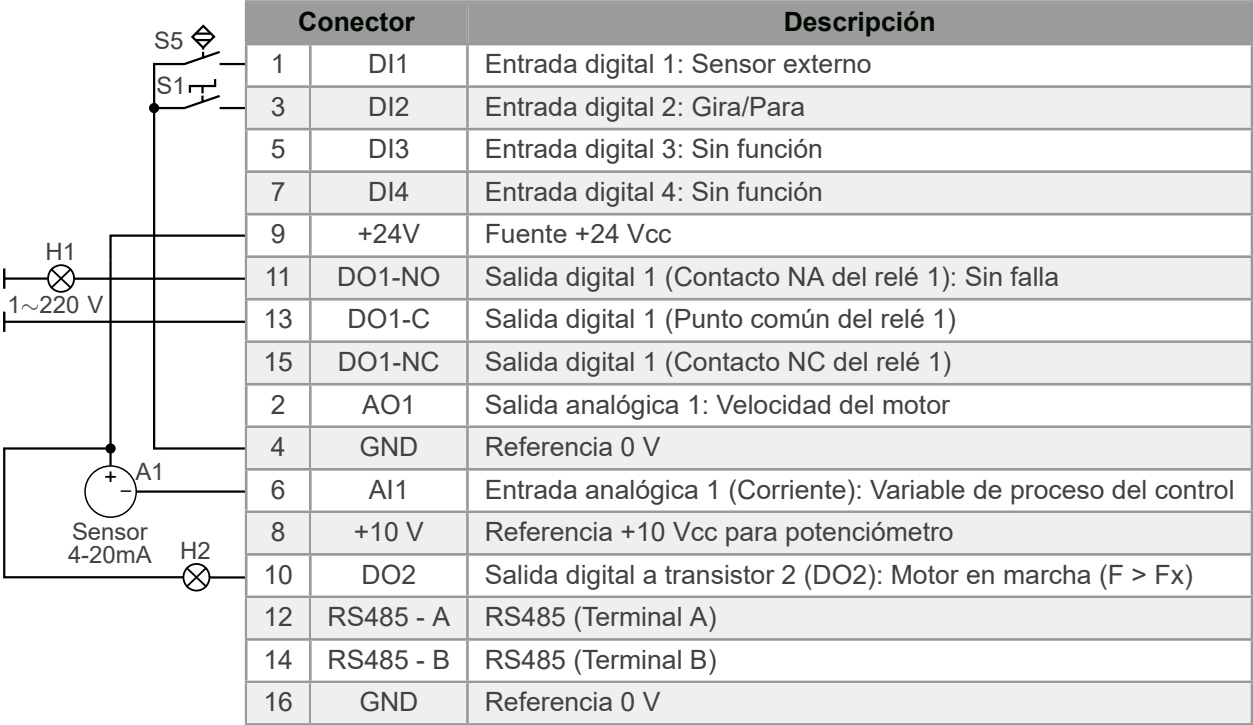
Figura 4.10: Señales en el conector del módulo plug-in CFW500-IOS para protección de la bomba vía sensor externo en la entrada digital DI1
