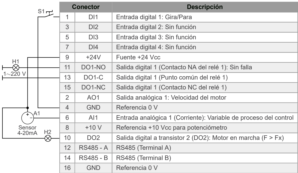
Figura 4.2: Señales en el conector del módulo plug-in CFW500-IOS para el setpoint del control vía HMI
