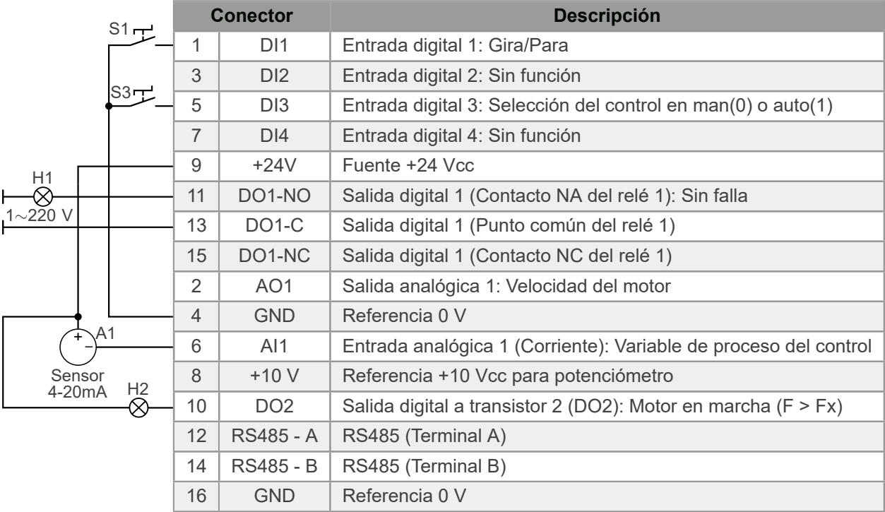
Figura 4.8: Señales en el conector del módulo plug-in CFW500-IOS para selección del controlador PID en manual o automático via entrada digital DI3
