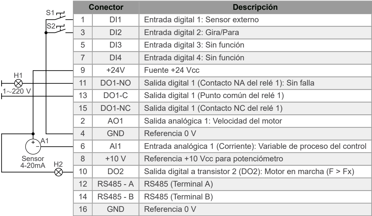
Figura 4.14: Señales en el conector del módulo plug-in CFW500-IOS para desatascamiento de la bomba con mando vía entrada digital DI2
