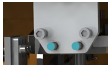
图 7.16：运动凸轮上的传感器（SE4 和 SE8）
