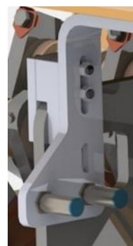
图 7.17：刷架臂上的传感器（SE1 和 SE5 / SE2 和 SE6）
