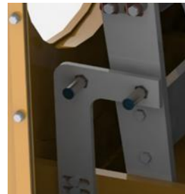
图 7.15：刷架驱动臂上的传感器（SE3 和 SE7）
