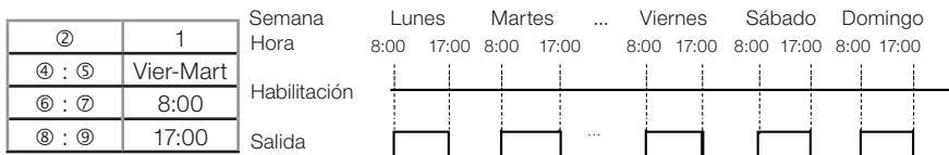
Esta programación invertida de los parámetros puede ser realizada simultáneamente para los días de operación y el horario de accionamiento, conforme observado en el ejemplo abajo:
