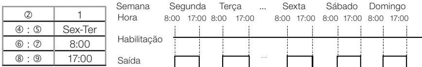
Esta programação invertida dos parâmetros pode ser realizada simultaneamente para os dias de operação e o horário de acionamento, conforme observado no exemplo abaixo:
