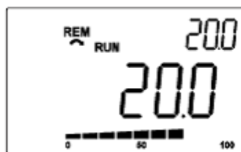
Figura 19.21: Exemplo da HMI no modo monitoração para a função Controlador PID2
