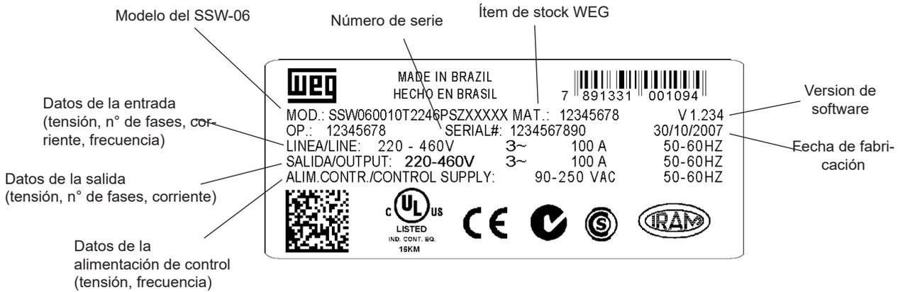
Figura 2.3 - Etiqueta de identificación del Arrancador Suave SSW-06
