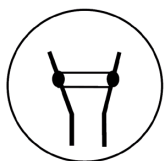
МЭК 60947-5-1 Механически связанные контакты
