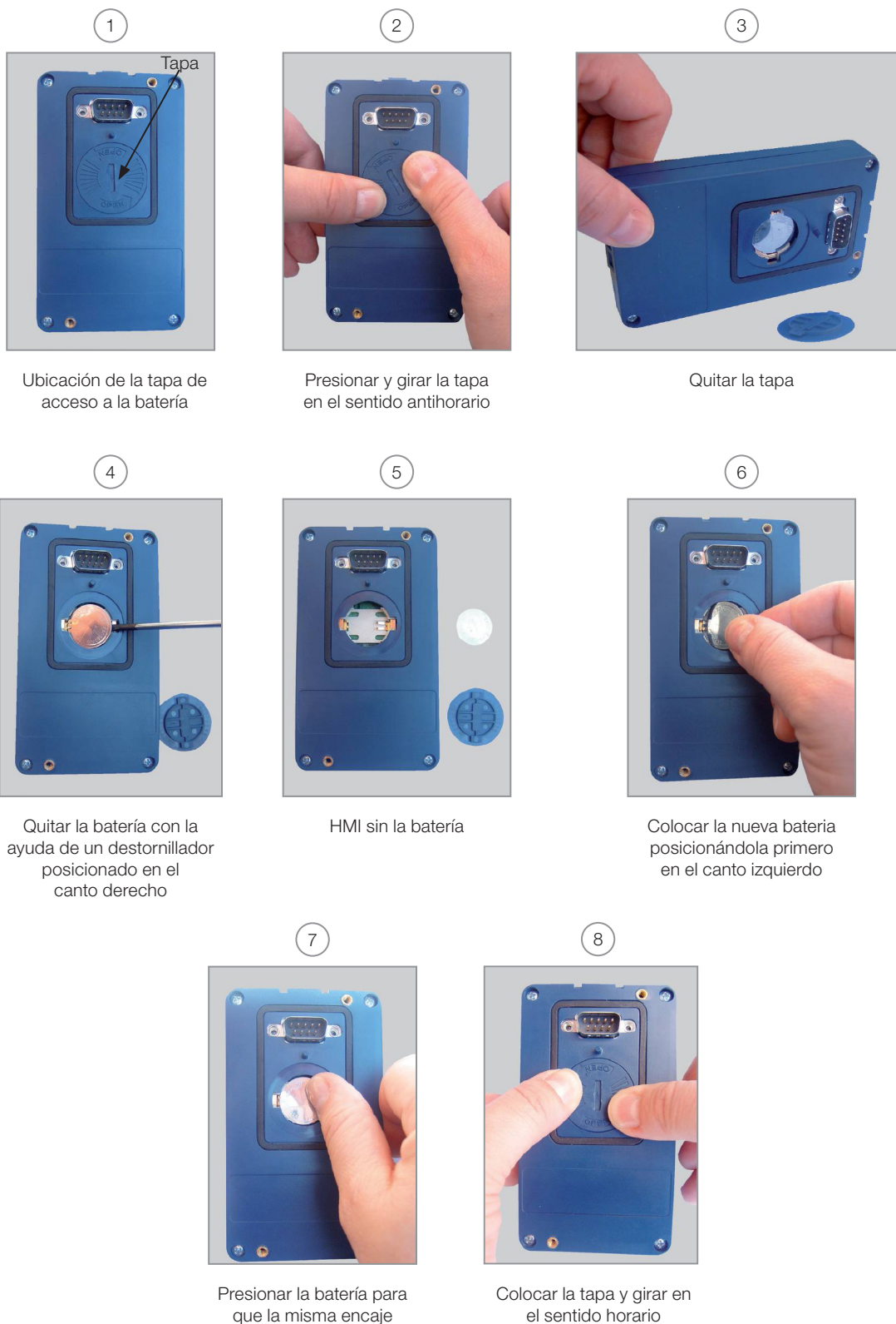
Figura 4.4: Sustitución de la batería de la HMI
