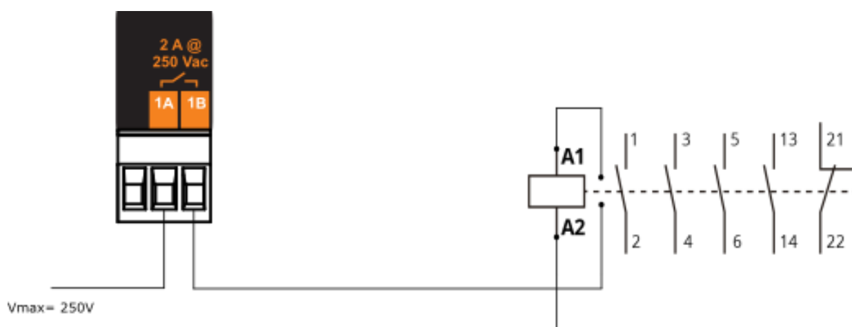
Figura 16 - Esquema de ligação Saída Digital
