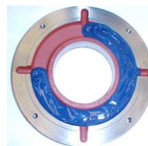
Figura 7.3: Anel de fixação externo do mancal
