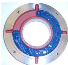
Figura 7.4: Anillo de fijación externo del cojinete
