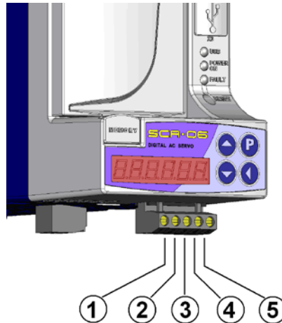
Figura 2.1: Detalhe do conector CAN na parte inferior do produto
