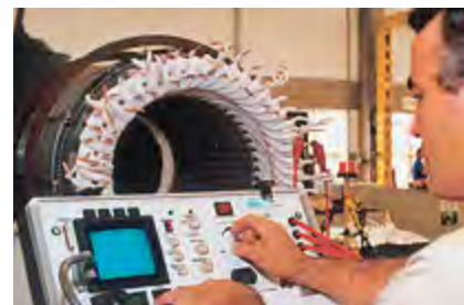
Ensayo de corto circuito
