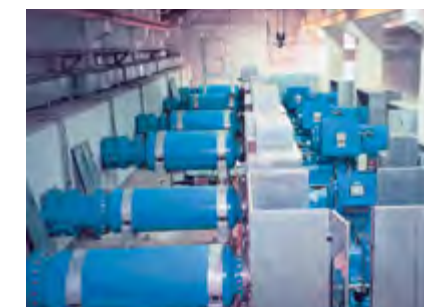
Suministro: 845HP, 6.600V, 2 polos Aplicación: Trituradoras Chile - Minería
