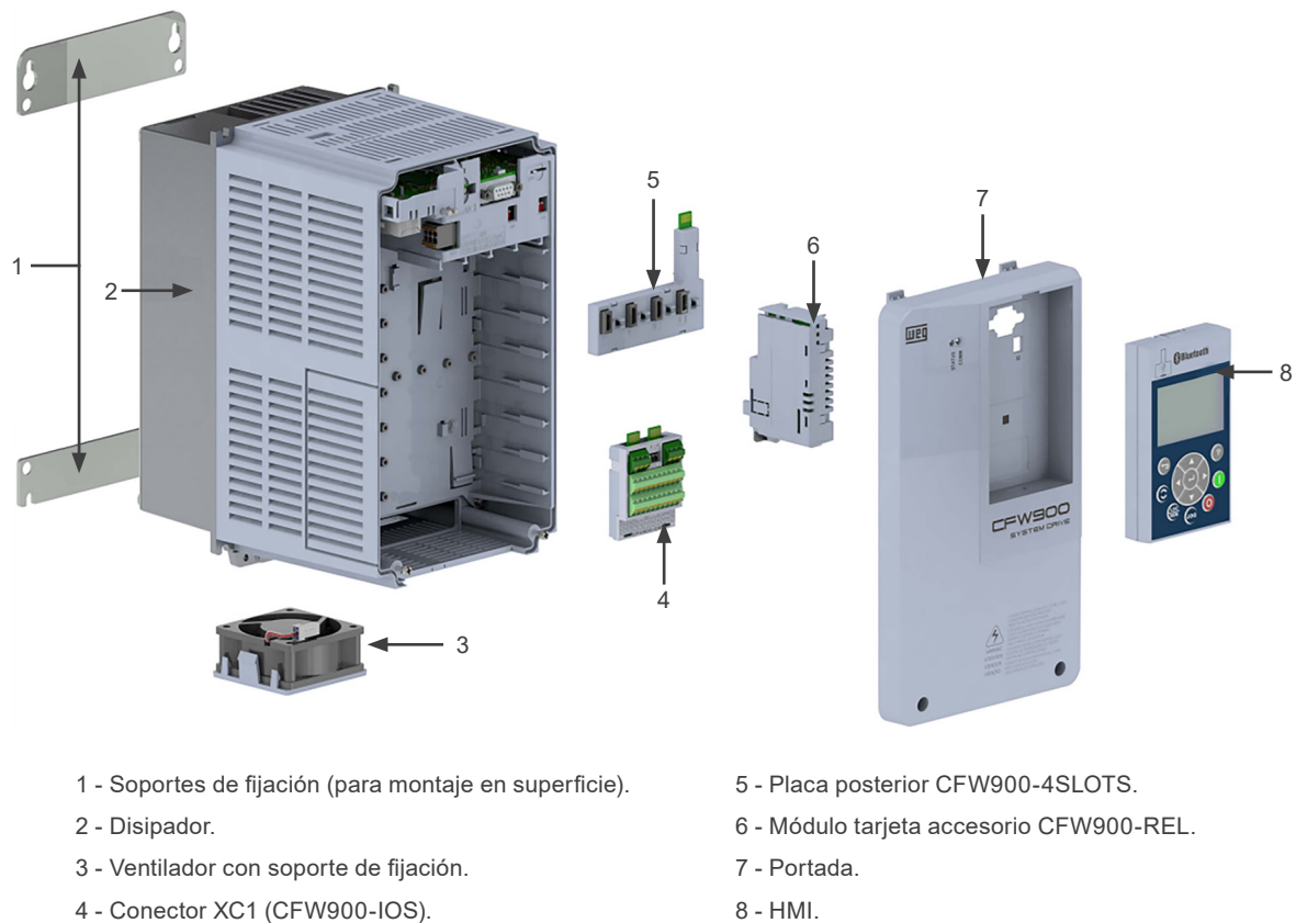
Figura 2.13: Partes del CFW900 tamaño A
