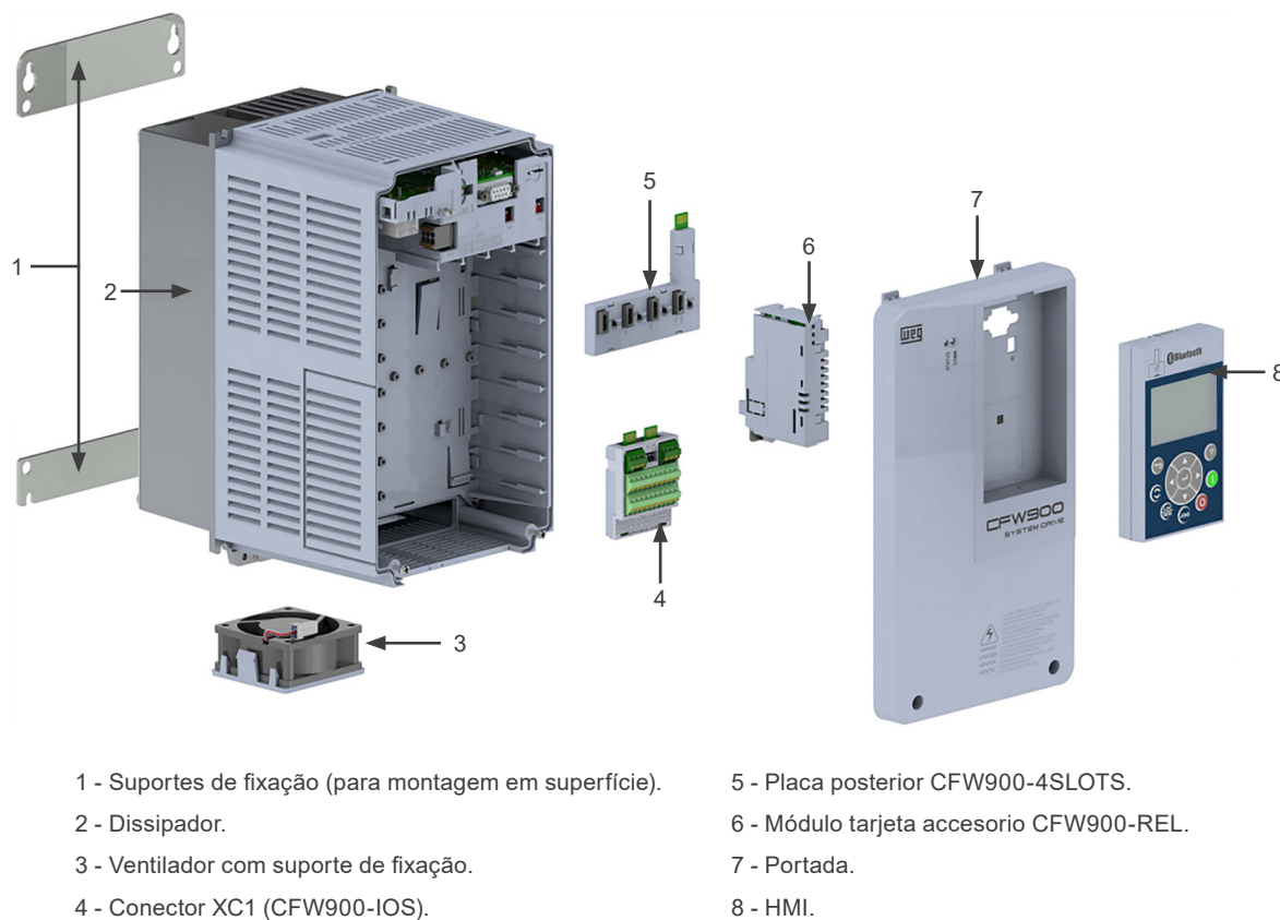
Figura 2.12: Partes do CFW900 mecânica A
