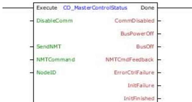
Tiene una entrada de habilitación para el bloque “Ejecutar” y una salida “Listo” que se activa una vez que la función ha terminado de ejecutarse. Si la entrada “Ejecutar” está activa actualiza los valores de las entradas y salidas y activa la salida “Listo”. Si la entrada “Ejecutar” no está activa, los demás valores de entrada se ignoran y todas las salidas se restablecen a cero.
