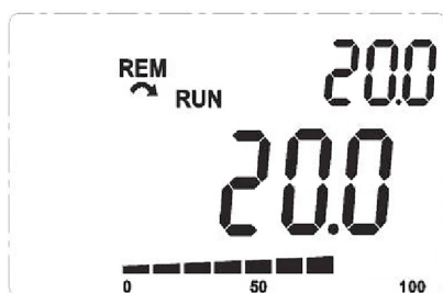
Abbildung 16.3: Beispiel für die MMS im Überwachungsmodus für den Gebrauch des PID-Reglers
