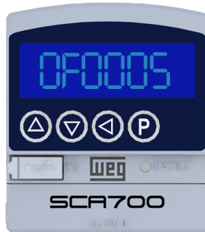
Figura 7.2: Exemplo de indicação de falha no display da HMI
