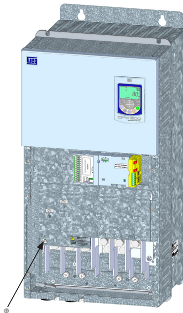
图A.4: 滤波电容器接地断开点的位置-分离槽螺栓-帧尺寸F和G
