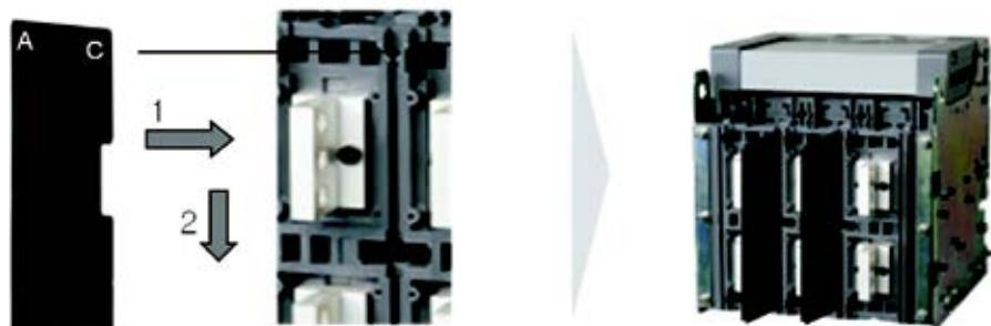
Figura 2.4: Instalación de las divisorias aislantes.
