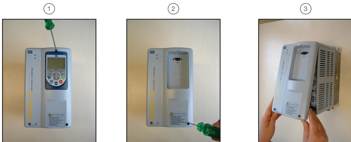
图3.5 - 拆除操作面板和前盖
