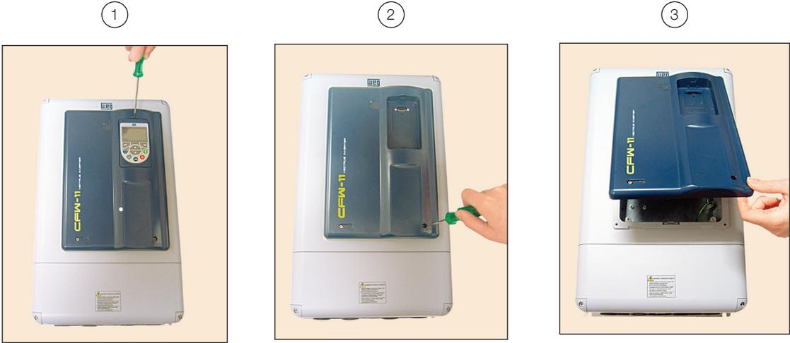
图3.6 - 拆除HMI和操作台盖板
