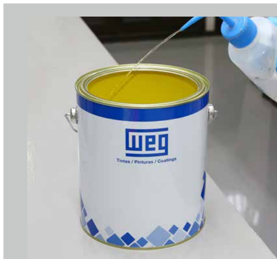
Etapa 1: parte do diluente de diluição sendo utilizado, com o uso de pincel, na limpeza da embalagem.
