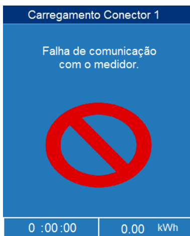
Figura 5.14: IHM - Falha de comunicação com o medidor de energia
