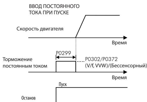
Рис. 12.10 - Использование торможения постоянным током при пуске
