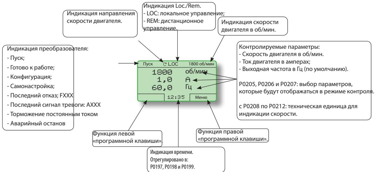
Рис. 5.3 - Экран режима контроля с заводскими настройками
