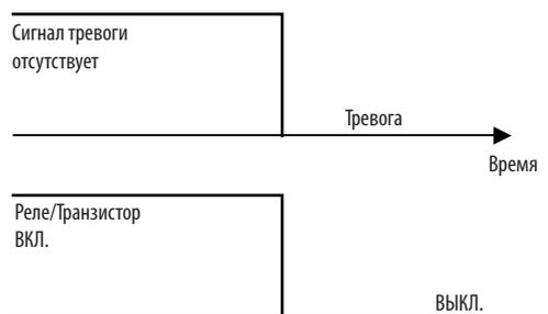
Рис. 13.9 - (а)-(s). Подробное описание работы функций цифровых выходов
