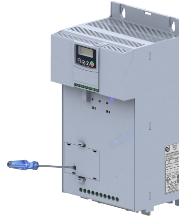
(d) Insert and tighten the M3 screw and washers (Torque 0.51 N/m) (d) Inserte y apriete el tornillo M3 y las arandelas (Torque 0,51 N/m) (d) Inserir e apertar o parafuso M3 e arruelas (Torque 0,51 N/m) (d) 插入並鎖緊 M3 螺栓和墊圈（扭力 0.51 N/m）
