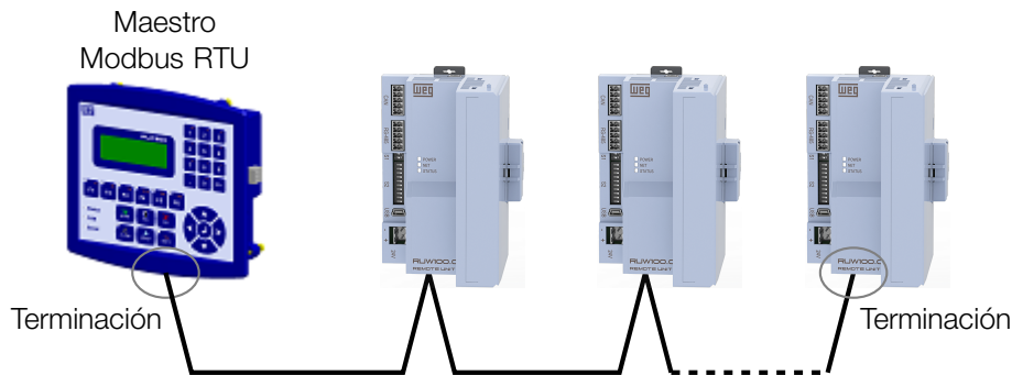
Figura 4.1: Ejemplo de instalación en red Modbus RTU
