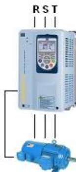
Figura 1.2.2 – Energização do hardware do Inversor
