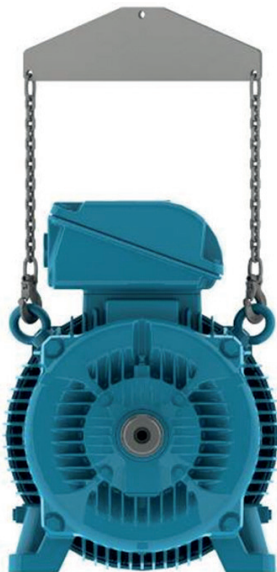
Εικόνα 4.7: Χρήση δοκού διαστολής για ανύψωση
