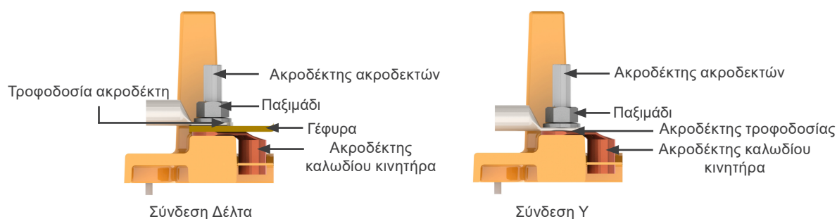
Εικόνα 6.15: Σύνδεση για μπλοκ ακροδεκτών KWLV* και KWMV*
