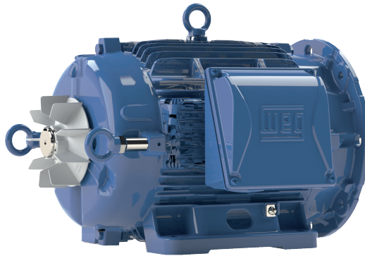
Εικόνα 4.14: Βίδες με άγκιστρο με προέκταση στερεωμένες στην πλευρά NDE για την τοποθέτηση του κινητήρα σε κατακόρυφη θέση, με το άκρο του άξονα προς τα κάτω (V5/V35)
