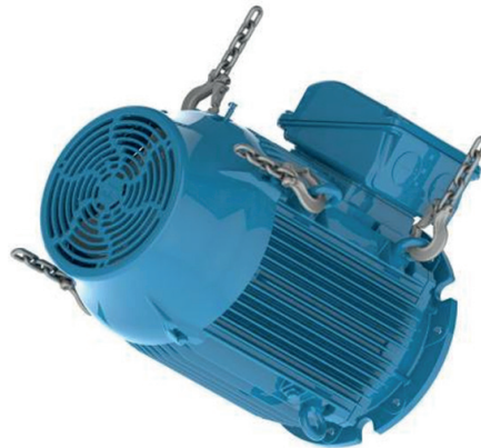
Εικόνα 4.21: Ο κινητήρας περιστρέφεται σε οριζόντια θέση
