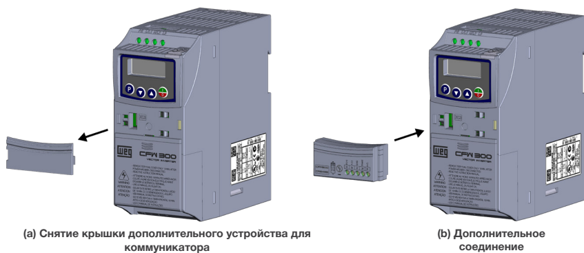
Рис А.3: (а) и (б) Слот 1 Коммуникационное вспомогательное устройство или внешний ЧМИ
