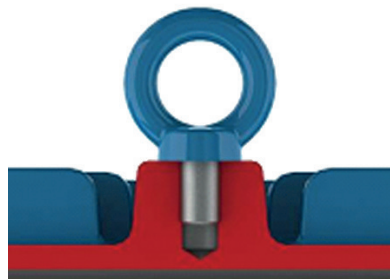
Figurii 4.1 - Strângerea corectă a unui șurub cu ochi
