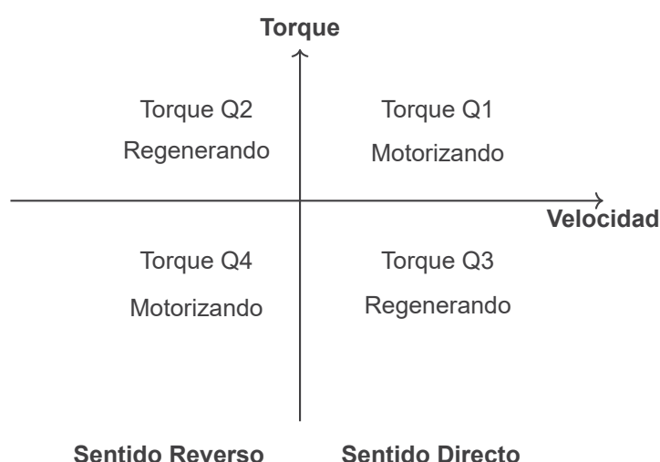
Figura 11.12: Convención de los limitadores de torque del motor en los cuatro cuadrantes de operación del motor
