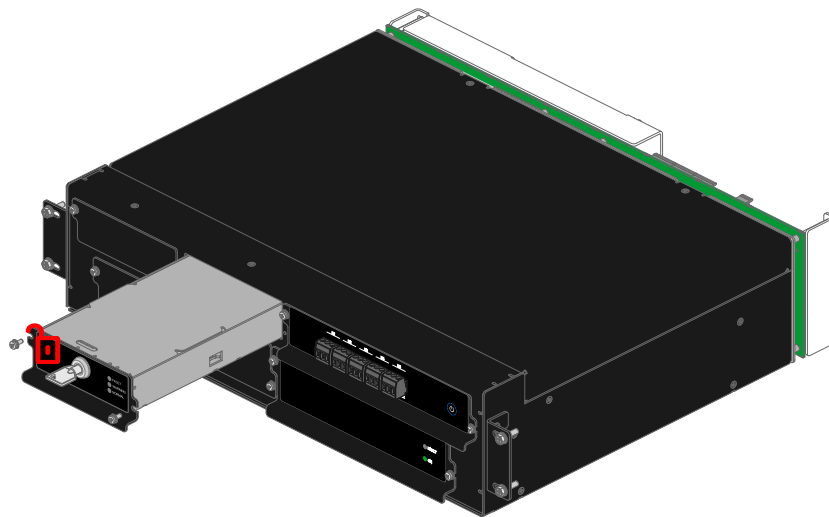
Figura 8.6: Módulo de control con la dispositivo de bloqueo hotswap en la posición destrabado (unlocked)
