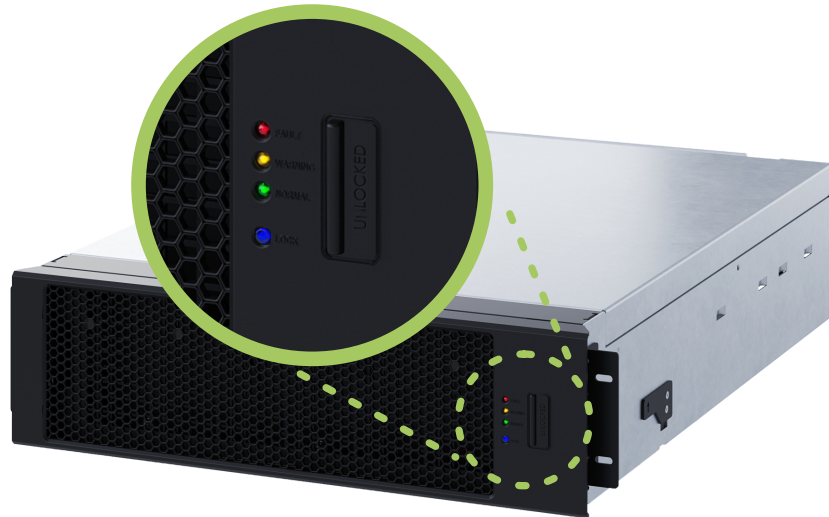
Figura 8.4: Módulo de bypass con la dispositivo de bloqueo hotswap en la posición destrabado (unlocked)
