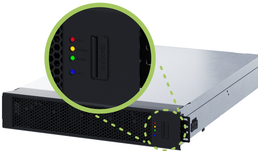
Figura 8.2: Módulo de potencia con la dispositivo de bloqueo hotswap en la posición destrabado (unlocked)
