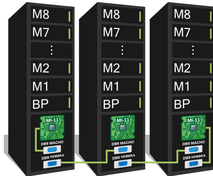
Figura 5.11: Ligaciones de los cables DB9 para paralelismo de rack
