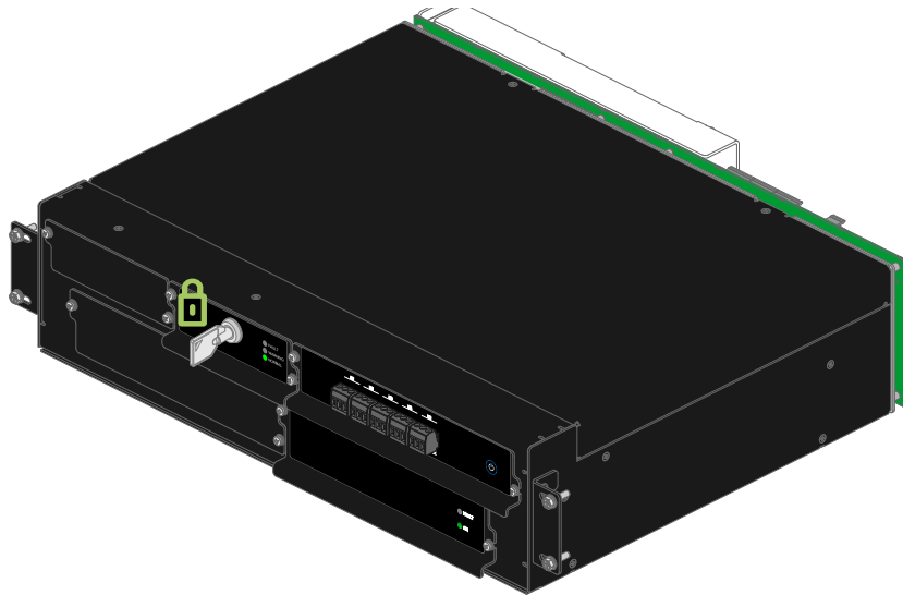
Figura 8.5: Módulo de control con la dispositivo de bloqueo hotswap en la posición trabado (locked)
