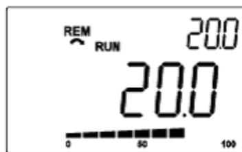
Abbildung 19.21: Beispiel für die MMS im Überwachungsmodus für die PID2-Controllerfunktion
