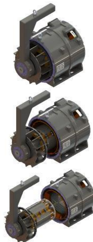
Figura 10.6: Rimozione del rotore principale con il dispositivo pendolare
