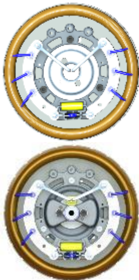
Figura 10.5: Vista frontale del rotore eccitatore GTA / AG10
