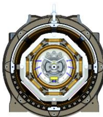
Figura 6.9: Supporto e resistenza tubolare installati nello statore dell'eccitatore
