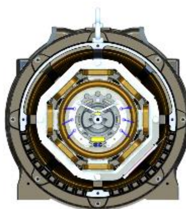
Figura 6.8: Supporto e resistenza tubolare installati nello statore dell'eccitatore
