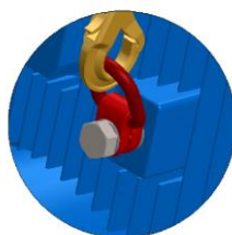
Рисунок 4-3 - Дополнительные рым-болты для перемещения двигателя с реберным охлаждением (не входят в комплект поставки двигателя)
