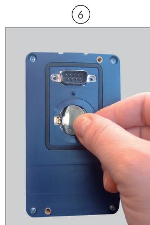
Installer la nouvelle batterie en la positionnant d'abord à gauche
