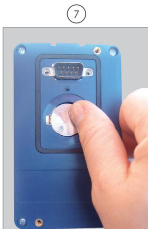
Appuyer sur la batterie pour l'insérer
