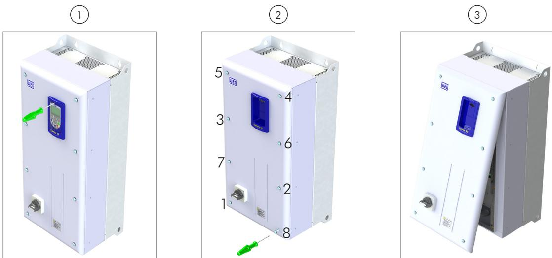
Remarque : La séquence de serrage pour le montage du couvercle avant est : 1-2-3-4-5-6 -7-8. Couple: 1,0 Nm.
