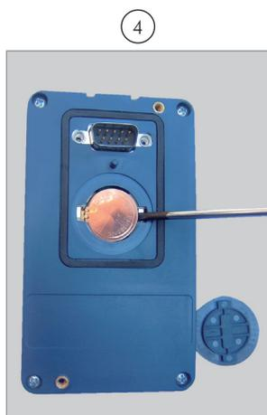
Sortir la batterie à l'aide d'un tournevis placé sur le côté droit
