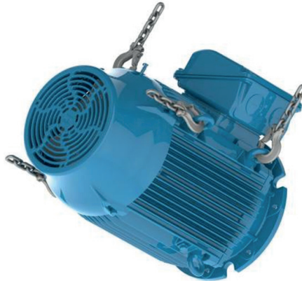
Figura 4.21: Il motore viene ruotato in posizione orizzontale
