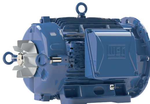
Figura 4.14: Bulloni a occhiello con prolunga fissati sul lato NDE per posizionare il motore in posizione verticale, con l'estremità dell'albero rivolta verso il basso (V5/V35)
