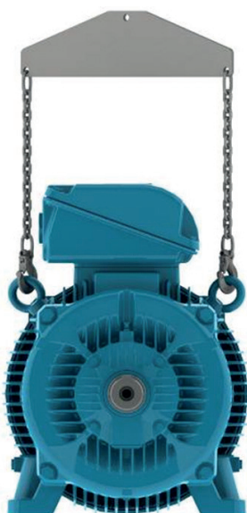
Figura 4.7: Utilizzo di una trave di sollevamento per il sollevamento
