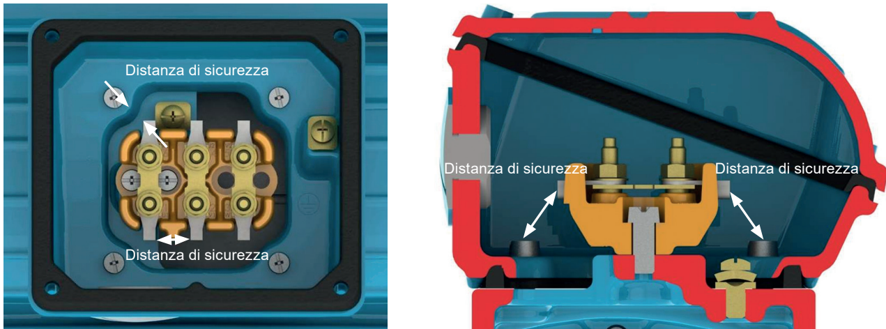
Figura 6.16: Distanza minima di sicurezza (mm) x tensione di alimentazione
