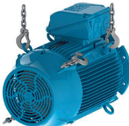
Figura 4.11: Installazione della seconda coppia di bulloni a occhiello
