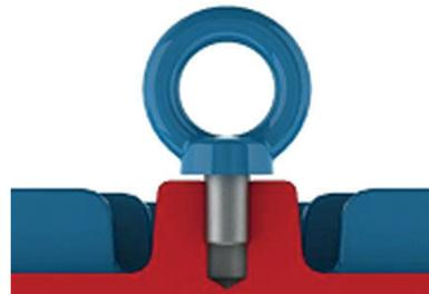
Figure 4.2 – Serrage incorrect de l'anneau de levage.
