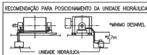
Figura 4.11: Unidade hidráulica
